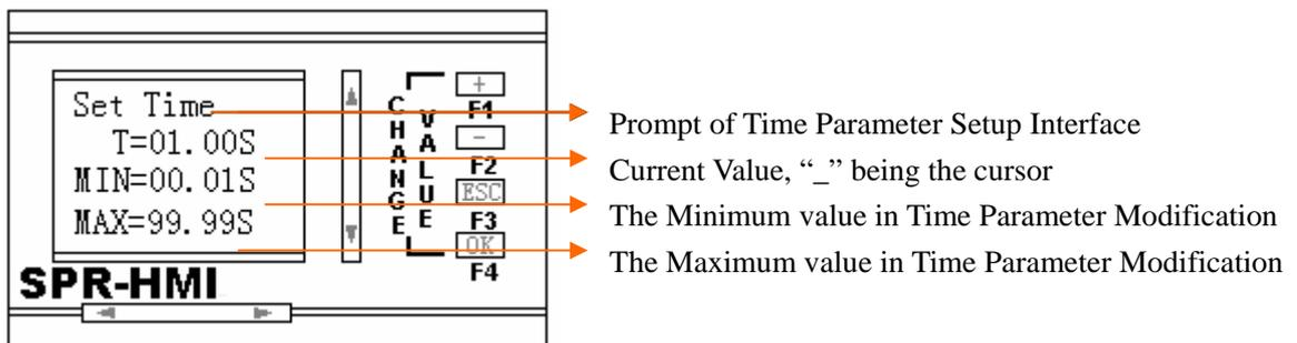
**Fig. 10.33 Time parameter Setup Interface**
