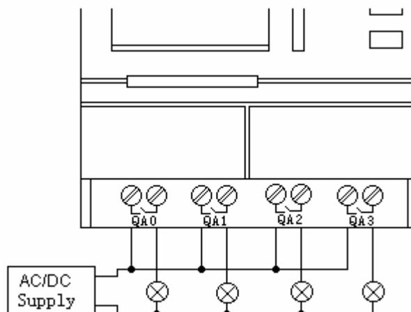
**Fig. 2.11 Relay Output**
